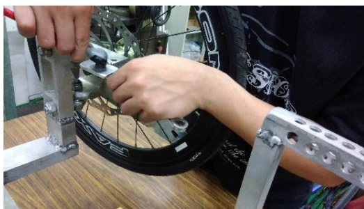
圖十七 轉向節的修正 (資料來源：研究者自製)
